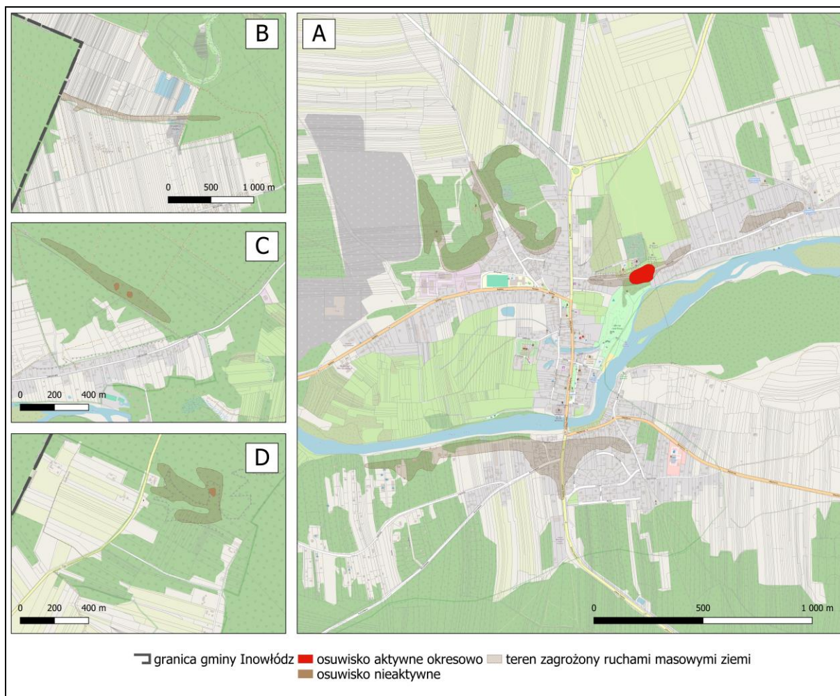
Rys. 3. Lokalizacja osuwisk oraz terenów zagrożonych ruchami masowymi w gminie Inowłódz (Źródło: Opracowanie własne -A. Grzelak, na podstawie danych PiG)
